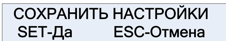
Рисунок 10 – Сохранение/отмена изменений настроек в блоке БВР.М
