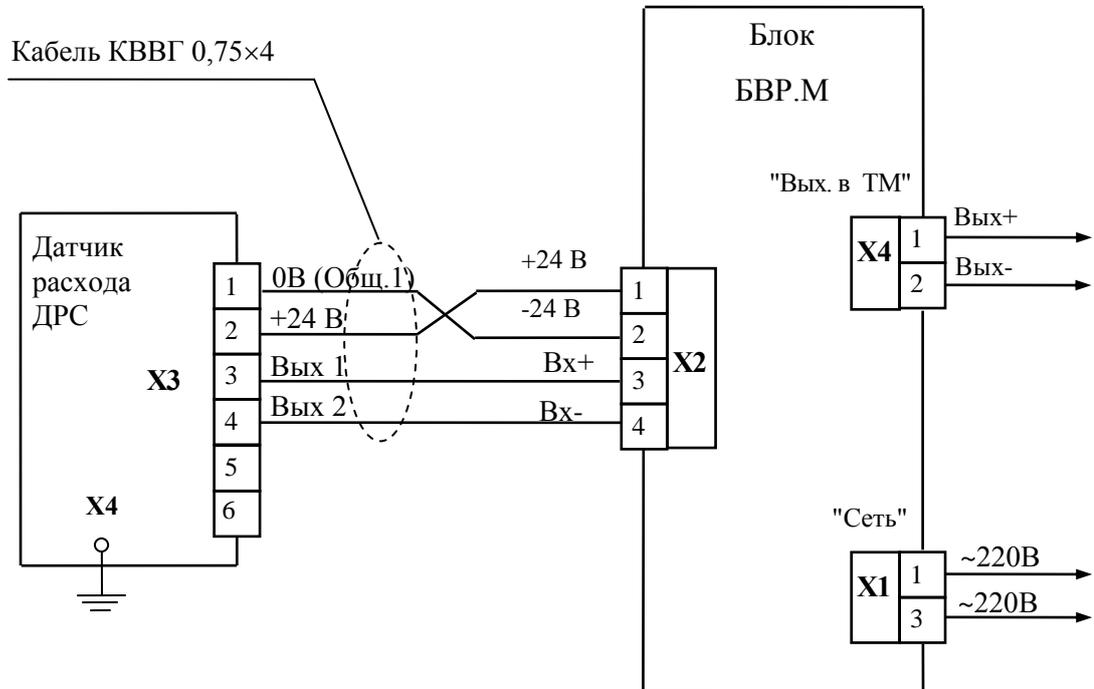
Рисунок В.2 – Схема соединений и подключения счетчика жидкости СЖУ с блоком БВР.М
