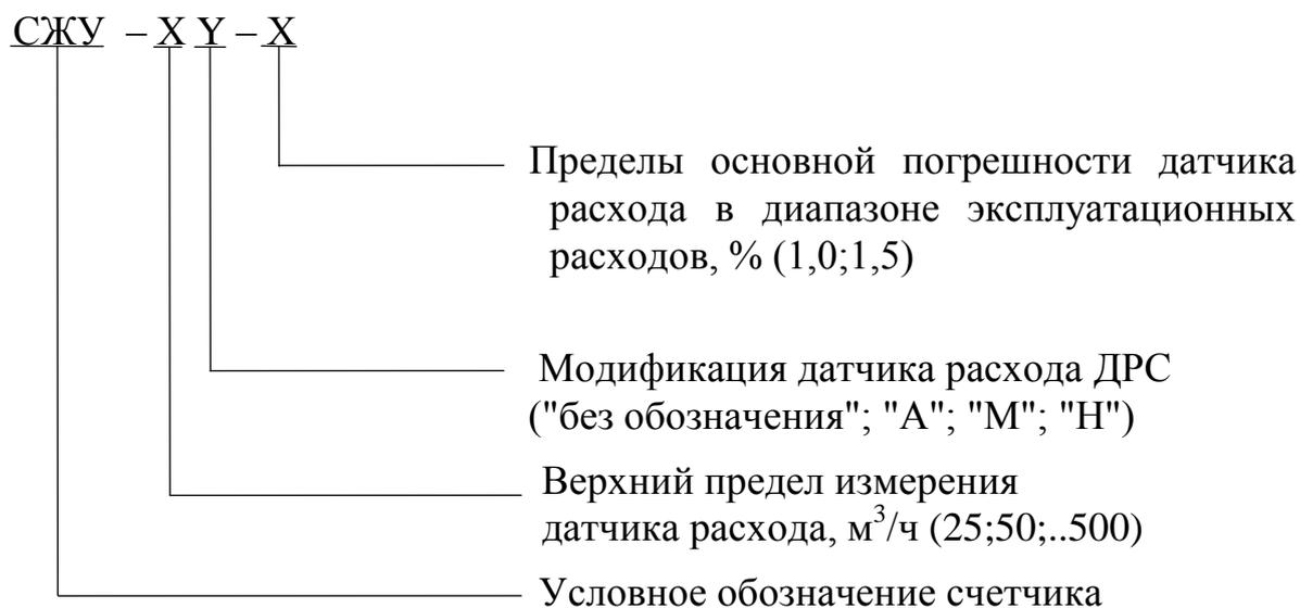
Пример: счетчик жидкости СЖУ, с датчиком расхода ДРС-100М, верхний предел измерения расхода 100 м<sup>3</sup>/ч, предел основной погрешности датчика расхода 1,5%: - СЖУ–100М–1,5.
