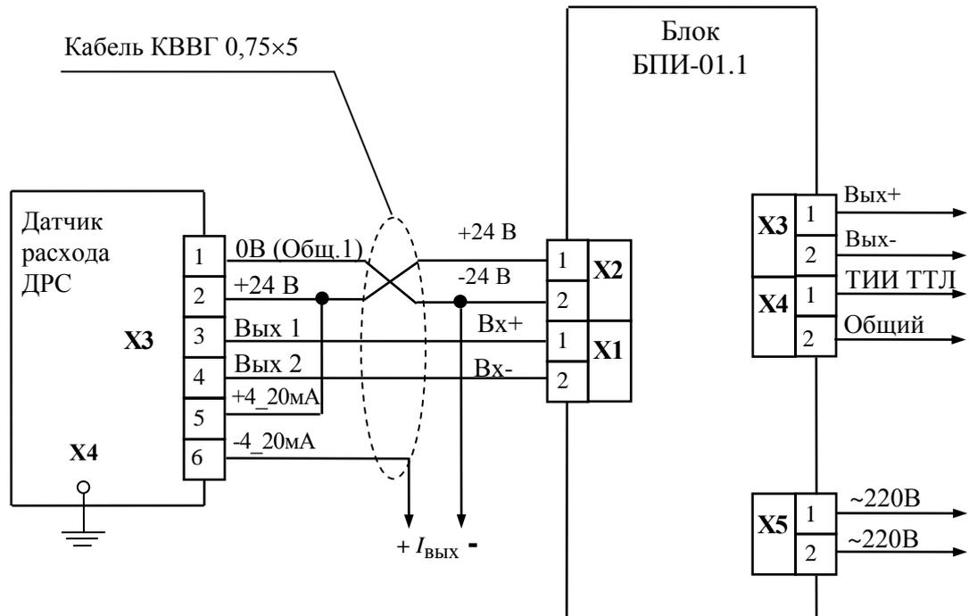
Рисунок В.1 – Схема соединений и подключения счетчика жидкости СЖУ с блоком БПИ-01.1
