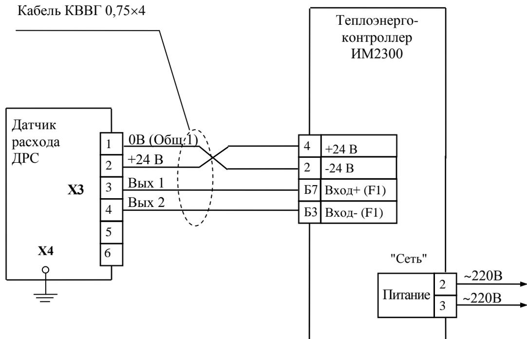
Рисунок В.3 – Схема соединений и подключения счетчика жидкости СЖУ с контроллером ИМ2300
