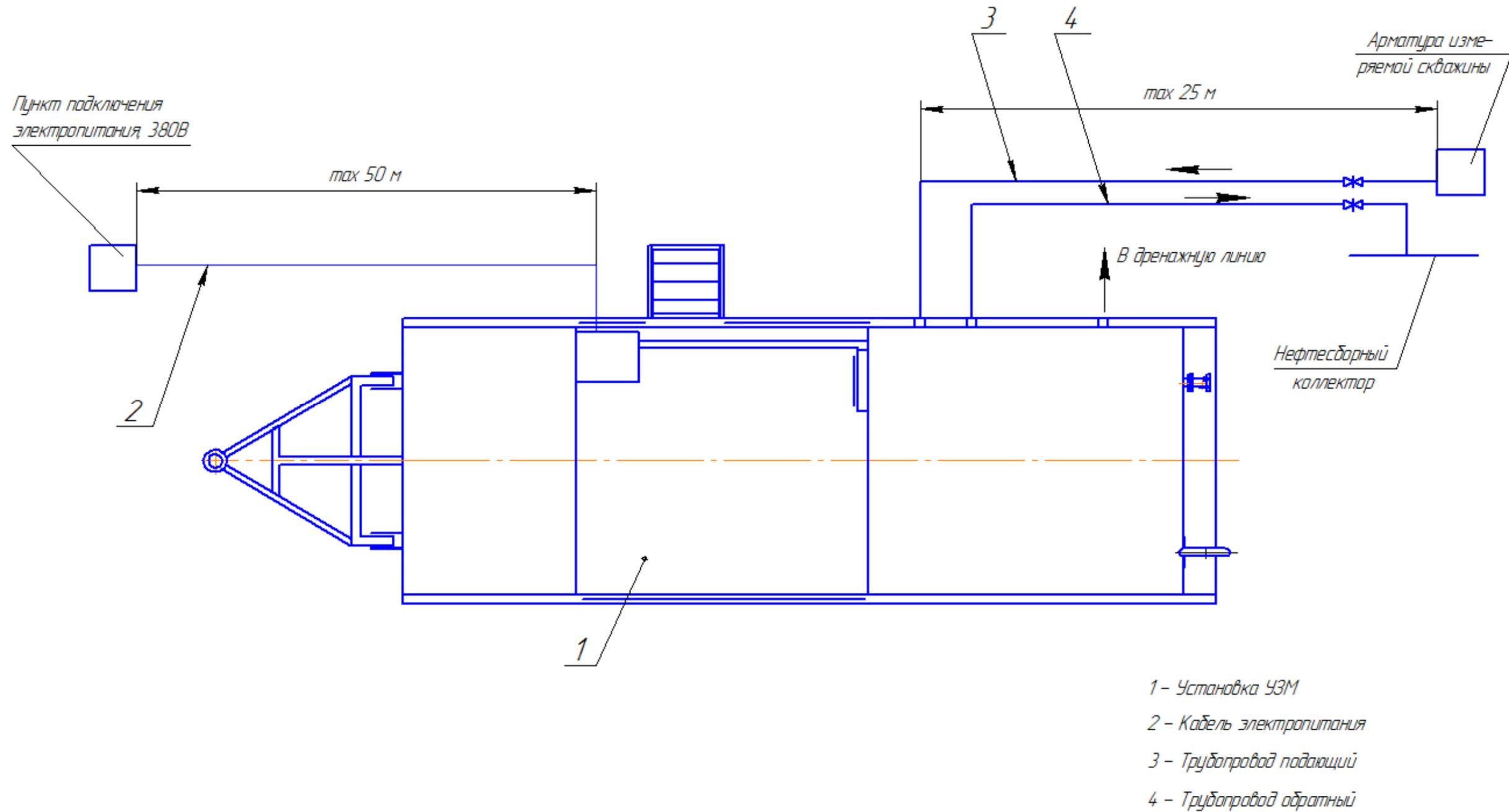
Рисунок Г.1 – Размещение установки измерительной мобильной УЗМ на месте эксплуатации
