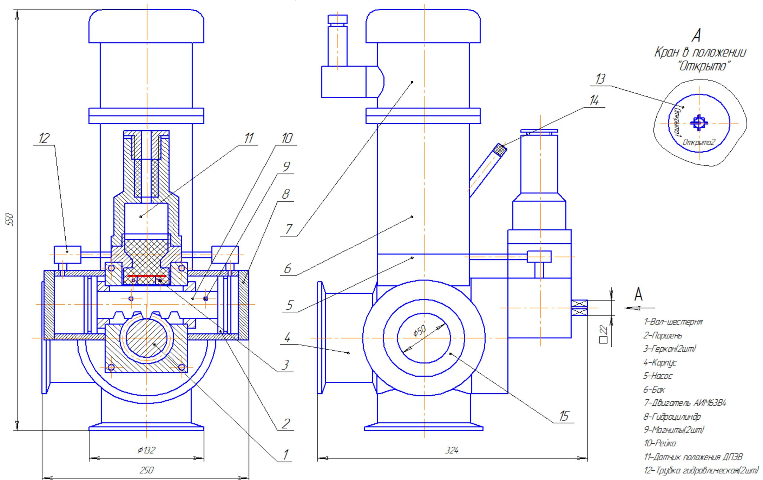
Рисунок В.2 Кран шаровой КЭ1. Общий вид
