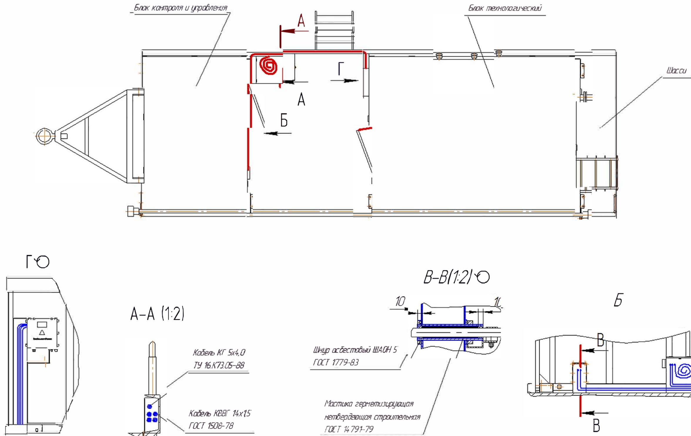
Рисунок Е.1 – Электромонтаж блоков на шасси.
