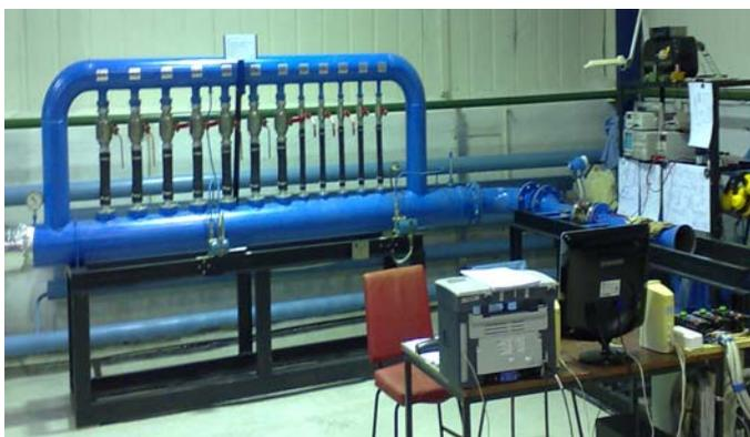
УСТАНОВКА ПОВЕРЧНАЯ ГАЗОВАЯ УПГ. МНМОСХЕМА
