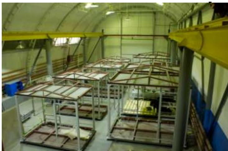
Блок-боксы могут быть использованы под размещение ЩСУ, НКУ, Блоков автоматики и другого технологического оборудования.
