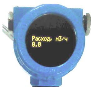
Рисунок 2 – Преобразователь ЭП с цифровым индикатором
